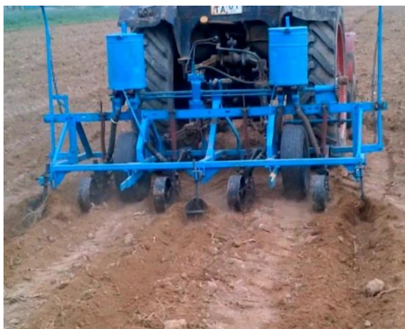
Расми 3. Тухмипошаки ТЗК-4 дар агрегат бо трактори МТЗ-82, чараёни кишти чуворимакка дар заминҳои оби ва ҳолати нашъунамои зироат.
