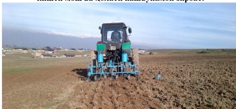
Расми 5. Тухмипошаки ТЗК-4 дар агрегат бо трактори МТЗ-82Х чараёни технологияи маъсарро дар заминҳои лалмӣ иҷро карда истодааст.
