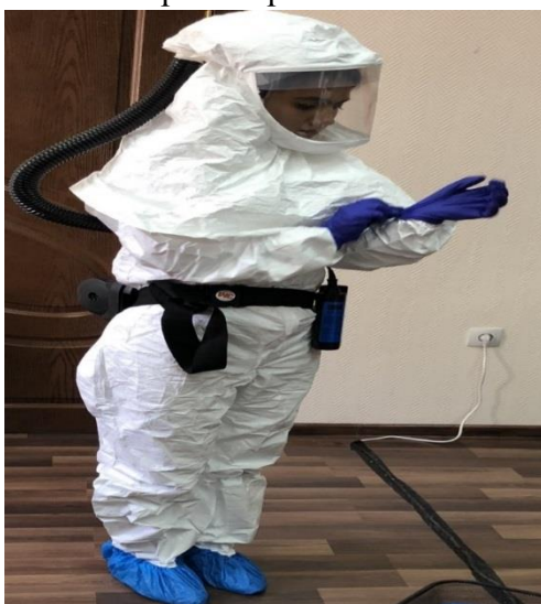
Рис.5. Специальная форма одежды и бур для отбора проб почвы от сибиреязвенных захоронений
