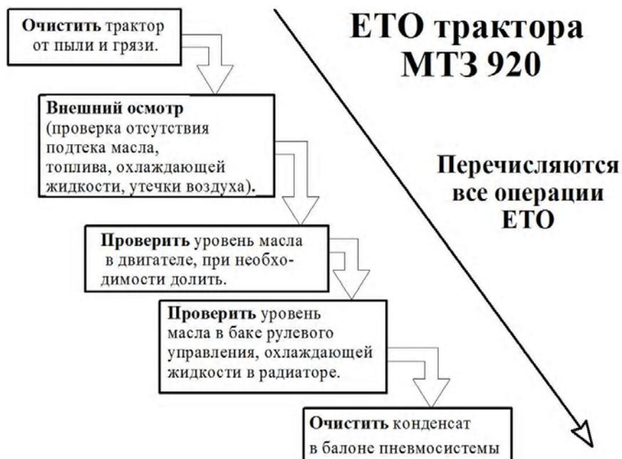
**Рис. 3 - Визуализация процесса ежедневного технического обслуживания (ЕТО) трактора МТЗ 920**
