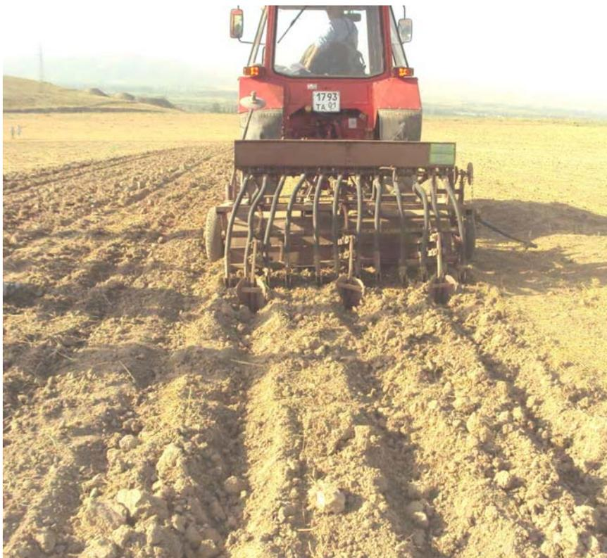
**Рисунок 1 - Общий вид комбинированного почвообрабатывающе-посевого агрегата МТЗ-82.1+КМ-1,8 "Кишоварз" при работе**
