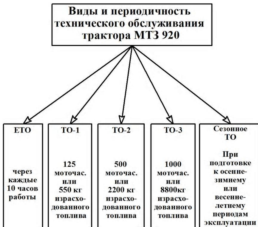
**Рис. 4. - Визуализация ТО трактора МТЗ 920**
