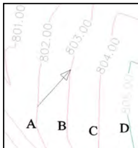
Расми 2. - Нақшаи масир бо истифода аз хатҳои горизонтӣ (скриншот аз Civil 3D)
