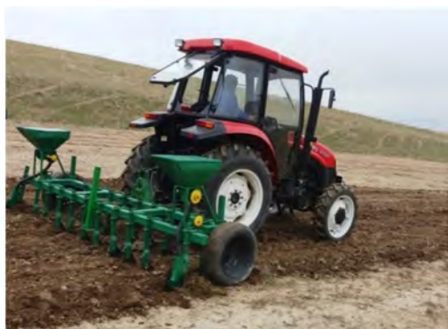
Рис. 1. – Общий вид МТА МТЗ-82.1+ КУБ-3,5 для ухода за посевами бахчевых культур
