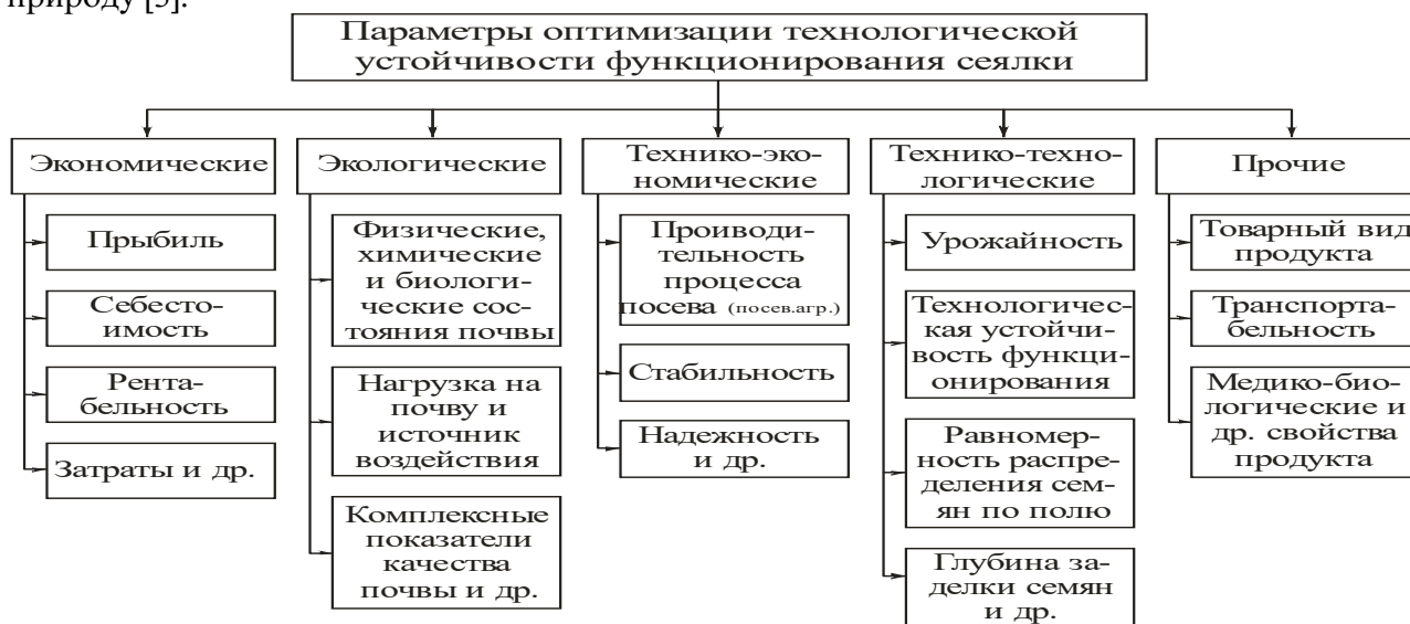
Рисунок 1 – Классификационная схема оптимизации параметров дозирующей системы УМСК
