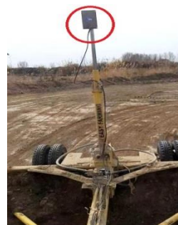
Расми 3. -Қабулкунаки лазерӣ (ресивер)
