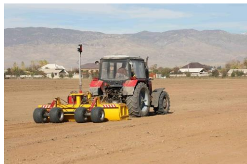
Расми 1.-Агрегати ҳамворкунаки лазерии муосир
