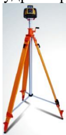
Расми 2.-Дастгоҳи интиқоли лазерӣ (Нивелир)
