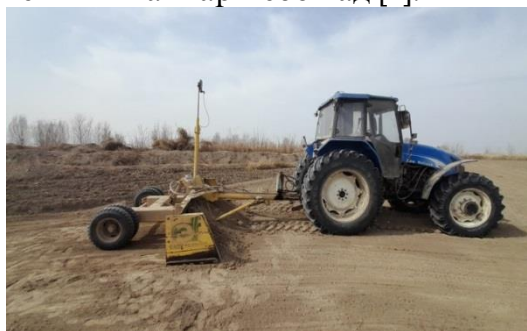
Расми 1.-Агрегати ҳамворкунаки лазерии муосир
