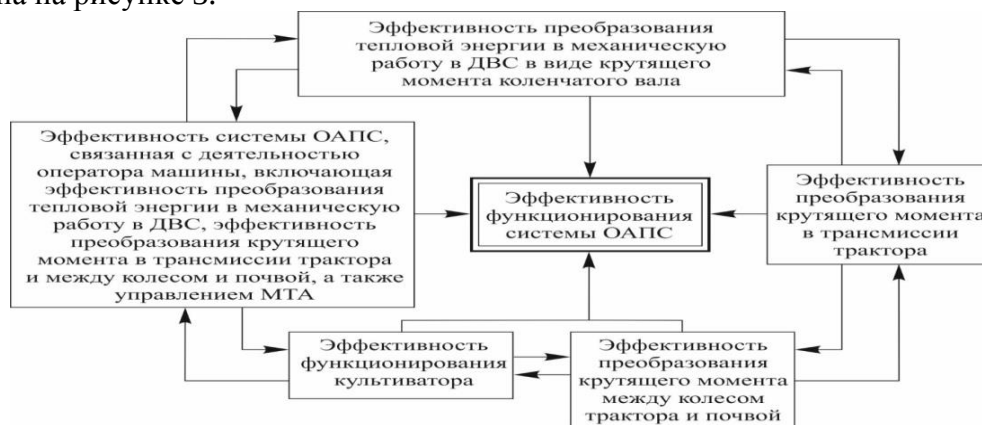
Рисунок 3. – Схема для оценки энергетической эффективности функционирования системы ОАПС
