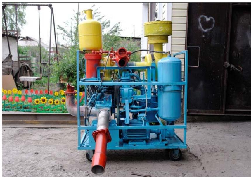
**Рис. 2** - Стенд для проведения экспериментальных исследований с гидроаккумулятором и тормозным устройством
