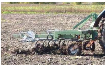
Рисунок 2 - Экспериментальный образец универсального комбинированного почвообрабатывающего агрегата блочно-модульной структуры УКПА-2,4 в работе
