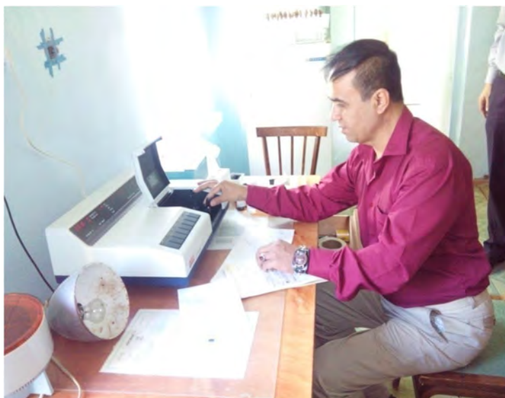
Расми 1.- Анализатори бисёрвазифавии DA-7200 (истехсоли ширкати Perten instrument-и Шветсия), раванди муайянкунии равғаннокӣ
