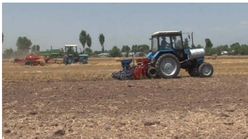
Рисунок 1 - Комбинированный почвообрабатывающе-посевной агрегат МТЗ-82.1+КМ-2,4 "Кишоварз" при выполнении технологического процесса
