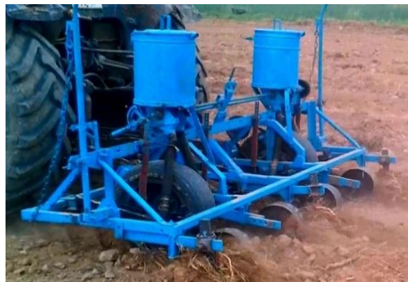
Расми 4. Тухмипошаки ТЗК-4 дар агрегат бо трактори МТЗ-82 дар ҷараёни технологияи кишти мош ва ҳолати нашономаи зироат.
