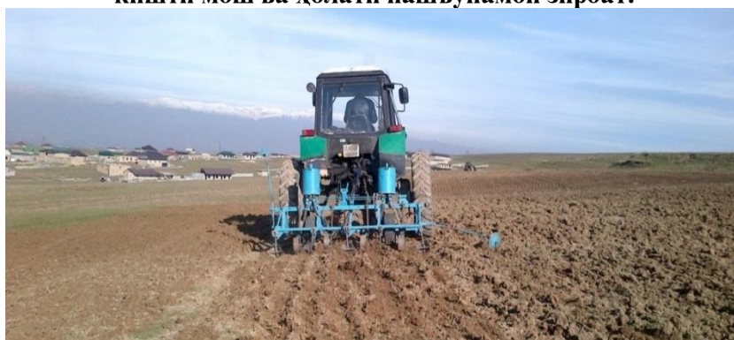
Расми 5. Тухмипошаки ТЗК-4 дар агрегат бо трактори МТЗ-82Х ҷараёни технологияи маъсарро дар заминҳои лалмӣ иҷро карда истодааст.
