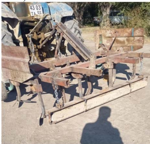
Расми 3. Намуди машинолоти мукамалкардашуда аз паҳлӯ кадоме, ки дар ду қатор ҷойгиршавии узвҳои панчагӣ, дар қисми қафогӣ мола ва дар қисми болои муҳофизаткунак ҷойгир шудааст (онҳо ба рама маҳкам карда шудаанд).
