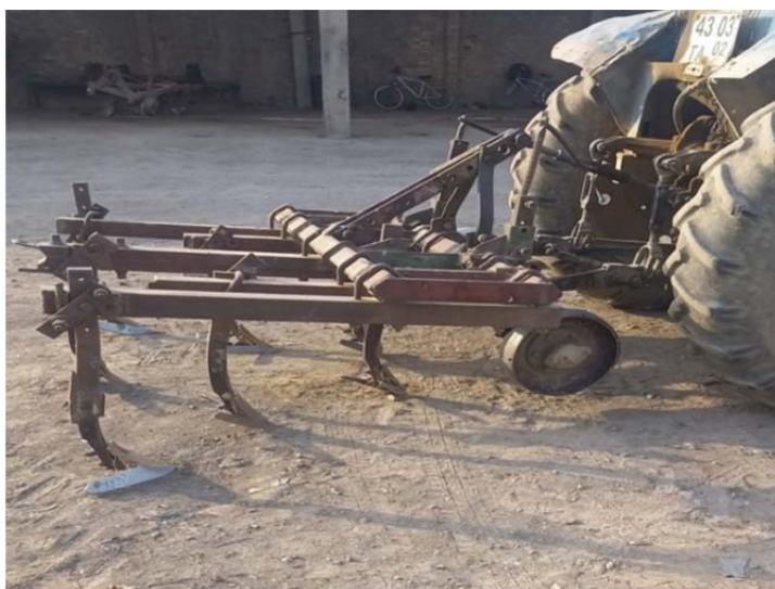
Расми 1. Намуди мошинолот аз паҳлӯ дар ҳолати вучуддошта, ки ба рамаи ПРВН-2,5 А бо 7 дона узви корӣ панчагӣ дорад ва бо ҷарҳ дар як қабати ҳокӣ дуруст карда мешавад.
