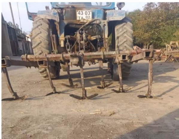
Расми 2. Намуди умумии машинолот аз қафо кадоме ки узвҳои кори панчагӣ ба брусҳои иловагии рама пайваست карда шудааст, ки барои гузоштани мола дар қисми қафогии он монеъгӣ мерасонад.
