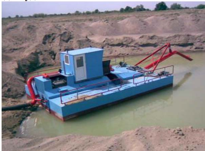
Расми 3. - Рафъи лойолудшавии обанбор бо истифода аз таҷхизоти ғайрихудгарди тамғаи Кибер Педия
